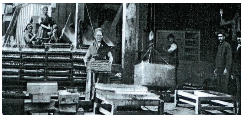
Fig. 4 - Interior de fábrica não identificada. No lado direito, a secagem da sardinha nas grelhas e no esquerdo, o “cofre” de fritura ( Ilustração Portuguesa , 11 de Julho de 1910, p.60).
