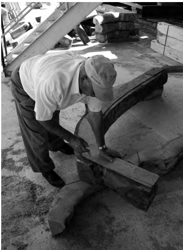
Fig. 3 - Passagem do desenho do molde do braço para a peça de madeira já pré cortada (Foto de Paulo Guerreiro).
