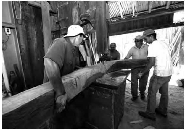
Fig. 5 - Acertos finais do braço, na serra circular, cortando pela linha do molde, o excedente de madeira da peça (Foto de José Presumido).
