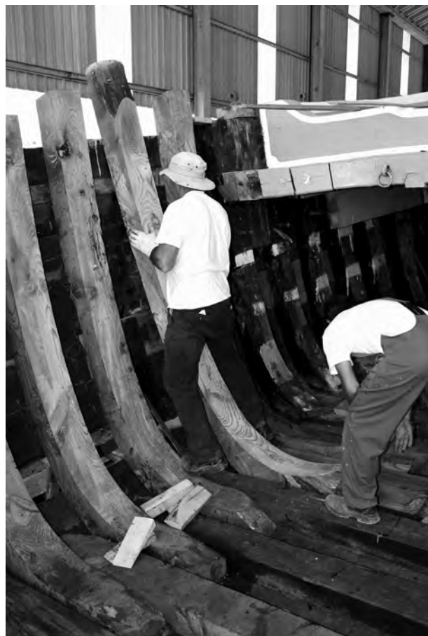
Fig. 7 - Montagem de um braço na embarcação (Foto de Paulo Guerreiro).
