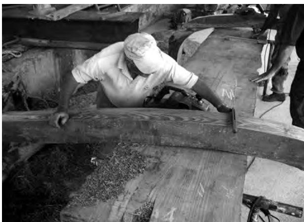
Fig. 4 - Trabalhar o braço, aplainando e medindo com suta as inclinações do braço (Foto de Paulo Guerreiro).
