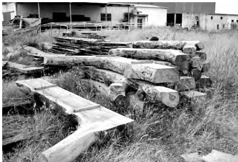
Fig. 2 - Madeiras empilhadas, apoiadas em pequenas travessas, de forma a permitir a ventilação entre os troncos para secagem (Foto de Paulo Guerreiro).
