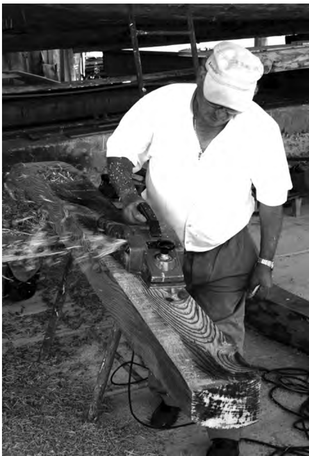
Fig. 6 - Aplinar uma das faces do braço, de forma a acertar a face nas medidas pretendidas (Foto de Paulo Guerreiro).
