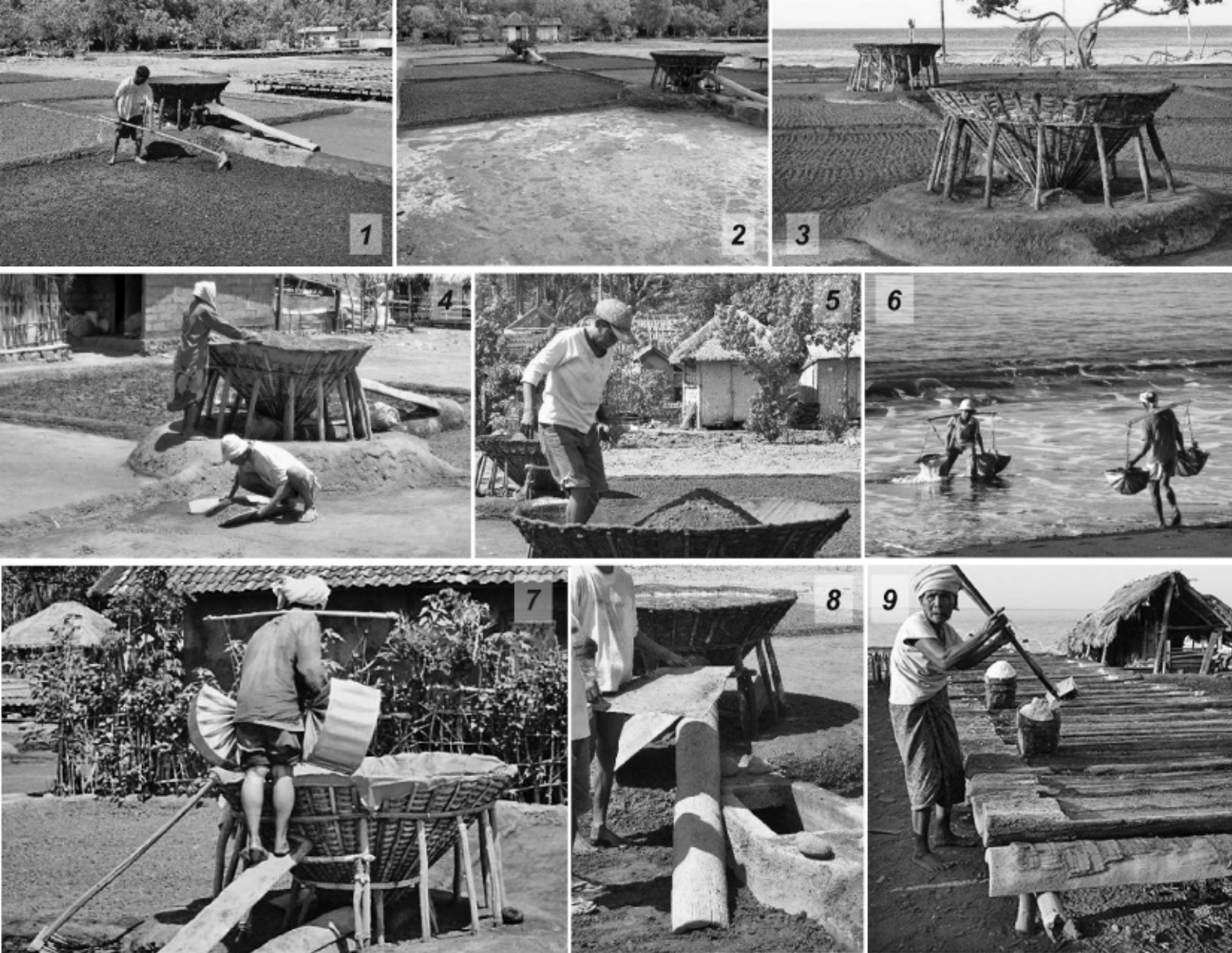
Fig. 9 - La production du sel marin sur la côte orientale de Bali, à Amed (Indonésie). 1- Le sable en haut de la plage est ratissé ; 2- Le sable retourné est saturé avec de l'eau de mer ; 3- Les paniers de filtration sont plantés à l'angle de 4 parcs ; 4- Récolte des sablons et versement dans les paniers ; 5- Le sable est tassé ; 6- Nouveaux va-et-vients vers le rivage pour puiser l'eau ; 7- Versement de l'eau de mer sur les sablons ; 8- L'eau filtrée et concentrée descend dans une fosse creusée dans le sol, ici aménagée pour être puisée sur le côté ; 9- La saumure cristallisée au soleil dans des demi-troncs d'arbre est récoltée à l'aide d'un racloir et d'une pelle (photos J. Daddy et S. Cassen).
