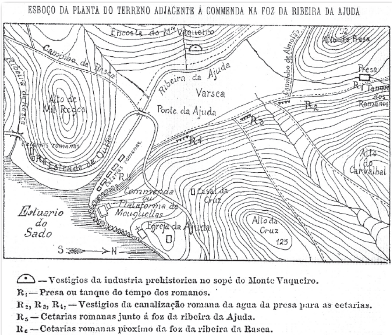
Fig. 16 - Carta arqueológica do vale inferior da ribeira da Ajuda, com indicação da barragem romana e do aqueduto que dali partia, em direcção às instalações fabris de preparados piscícolas existentes junto à confluência com o Sado (Costa, 1905, Fig. 181).
