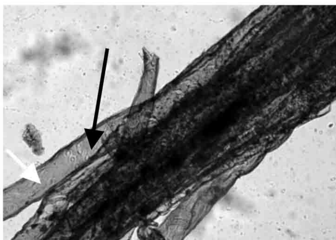
Fig. 4 - Madeira dissociada da amostra analisada: traqueídeos longitudinais (T); pontuações areoladas dos traqueídeos (seta branca), pontuações pinoídes do campo de cruzamento (seta preta) 100x.
